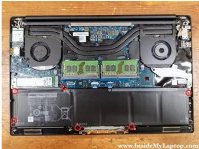
Exemple d'étape de démontage d'un ordinateur, qui indique où se trouvent les prochaines vis à démonter (entourées en rouge). Source : [insidemylaptop.com](http://insidemylaptop.com)
