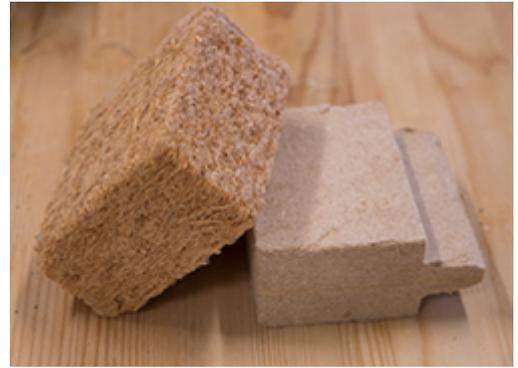
Les panneaux en fibres de bois sont fabriqués à partir de déchets de scieries (écorces et branches de résineux non traitées chimiquement). Les fibres sont agglomérées par leur propre résine (la lignine). C'est de la colle synthétique qu'on utilise lorsque plusieurs panneaux sont collés ensemble pour obtenir une plus grosse épaisseur d'isolant. Mieux vaut opter pour des panneaux non bitumés : leur caractère hydrofuge est assuré par des résines naturelles.
