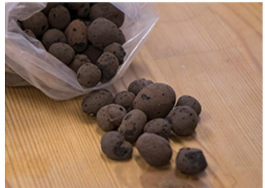
Elle est vendue en vrac pour être incorporée dans des bétons ou mortiers légers ou déversée sous une chape. Elle est utilisée comme constituant de blocs de construction préfabriqués.
