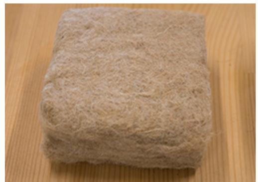
L'isolant en lin est fabriqué à partir de fibres de lin trop courtes pour un usage textile. Il est imprégné de sel de bore (potentiellement toxique pour la reproduction) pour le rendre résistant aux moisissures, aux insectes, au feu et aux rongeurs.
