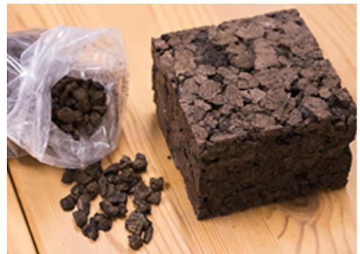
Le liège provient de l'écorce du chêne-liège. Les écorces sont réduites en grains qui sont ensuite agglomérés à chaud par la résine du liège (la subérine). Il est préférable d'éviter les panneaux renforcés avec des colles synthétiques : ceux-ci dégagent du formaldéhyde (cancérigène).
