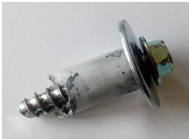
*Cette vis fixe le moteur sur la cuve. Avec une cuve en plastique, si le pas de vis casse, il faut remplacer toute la cuve.*
