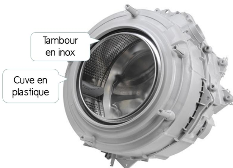
Auparavant, la cuve était également en inox mais de plus en plus de machines ont une cuve en plastique. Le principal problème de ces cuves en plastique est qu'elles sont moulées. Si la fixation du moteur ou un roulement casse, on doit remplacer toute la cuve, ce qui coûte cher.
